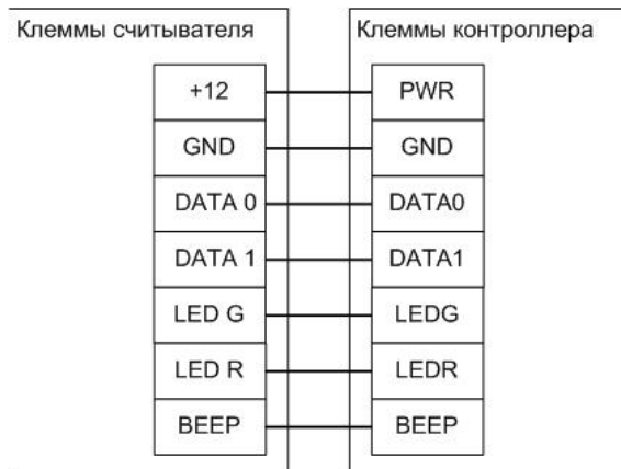
Пример подключения считывателя с напряжением питания, равным напряжению питания контроллера.
